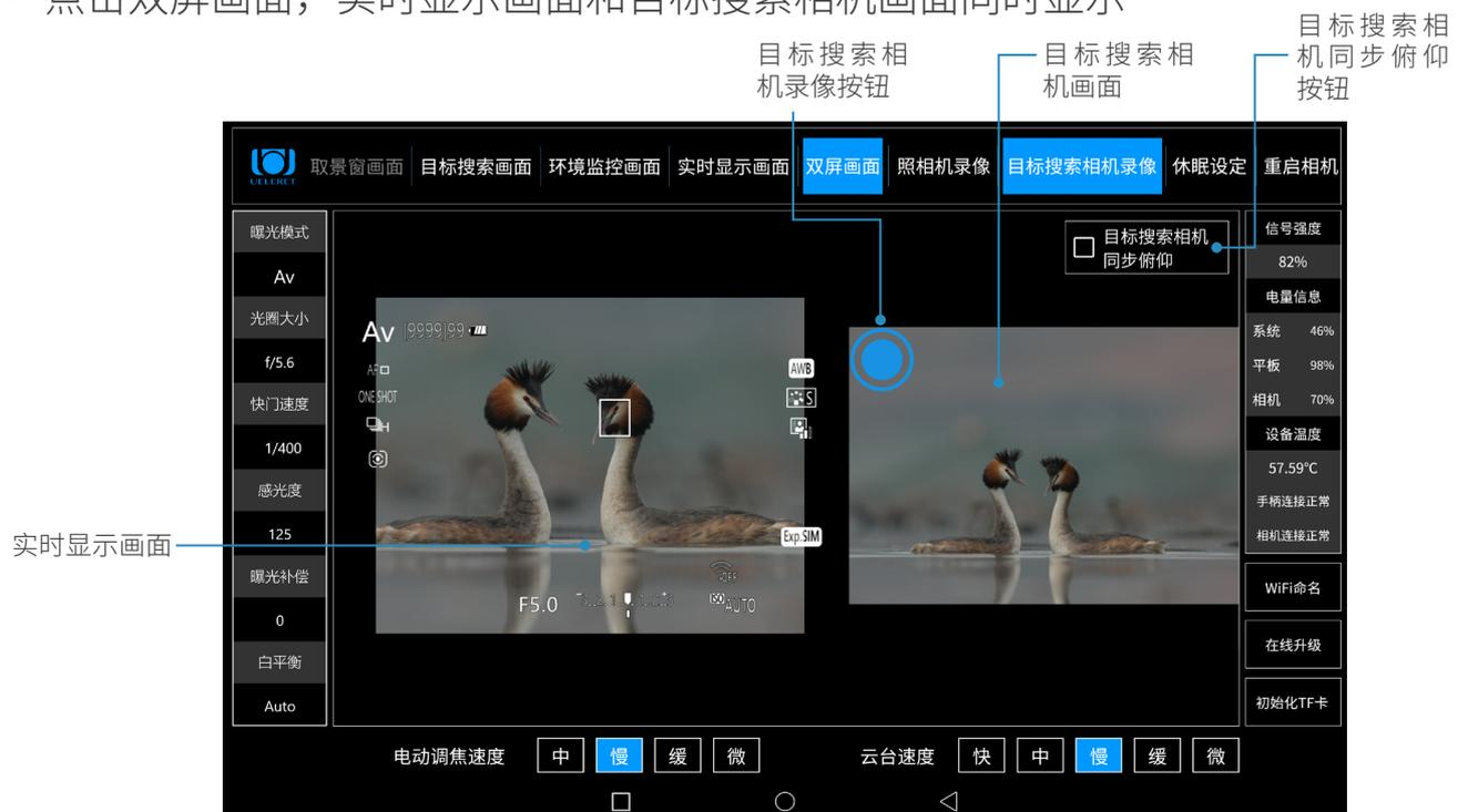
该界面，左边是照相机实时显示画面，右边是目标搜索相机拍摄的画面，此时可以通过手柄遥控执行照相机拍摄静态照片，也可以通过平板电脑执行目标搜索相机录像功能，或者两者同时进行。点击同步俯仰，目标搜索相机画面将随实时取景画面的俯仰同步俯仰。详情见 P24 页。
